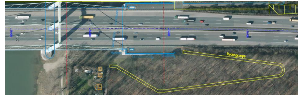
Abb.: Beispiel einer provisorischen Radwegrampe während der Bauphase - rechtsrheinisch
